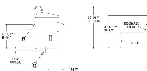
MODEL 6430 & 6430-T MODEL 6460 & 6460-T PEELER (WITHOUT TRAP)
